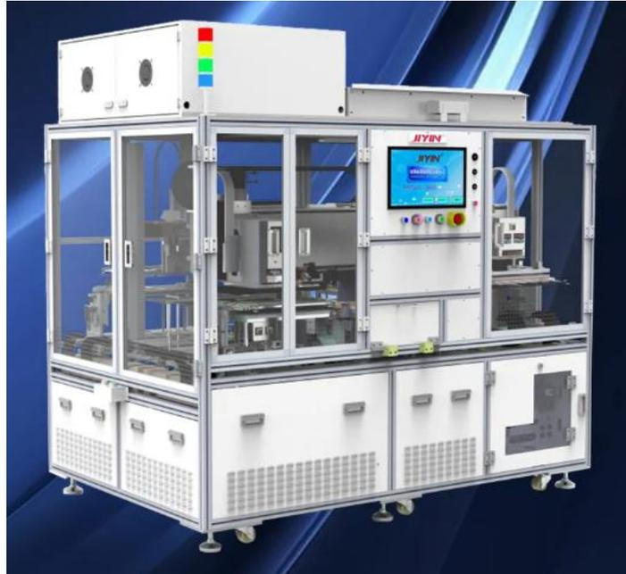
全自动覆盖膜贴附机主要应用于 FPC 基材与 CVL 覆盖膜的加热预贴附工艺，集自动上下料，自动撕膜为一体的全自动贴附设备。
